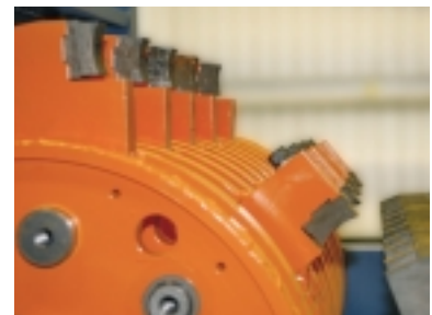
... rivarhuset , där de kraftfulla slagorna sönderdelar materialet till önskad grad.
