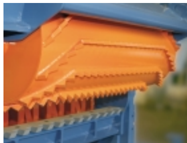
...den hydrauliska inmatnings- valsen som matar in det i...
