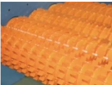
De lastkännande, flisseparerande matarhjulen för fram råmaterialet till...
